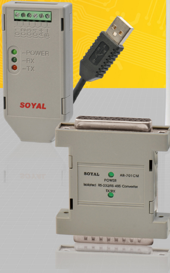
隔離型USB/RS-485轉換器 AR-321CM
